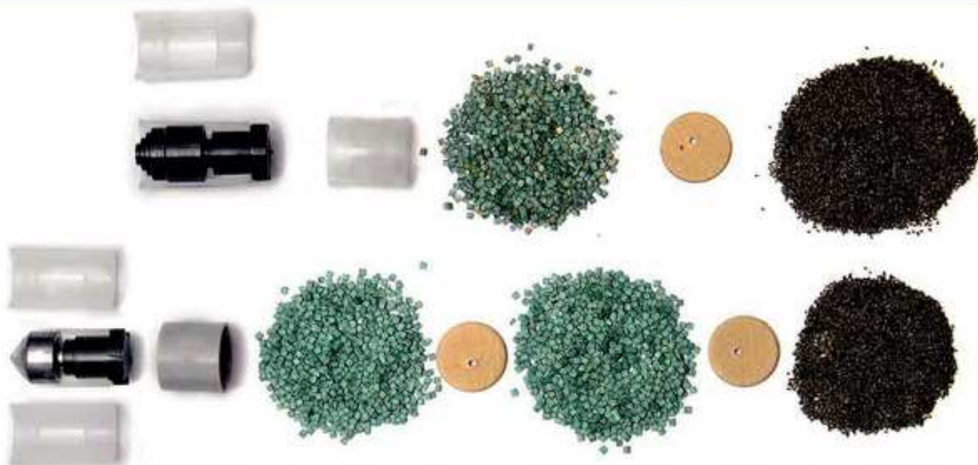
Снимок наглядно демонстрирует начинку патронов «Искра-М» с бинарным (пуля ППСг) и тринарным (пуля ППСв) зарядами. Отечественный порох «Сунар 42», как продукт с наименее устойчивыми свойствами, располагается в заряде первым и воспламеняется непосредственно формирующимся форсам пламени капсюля
